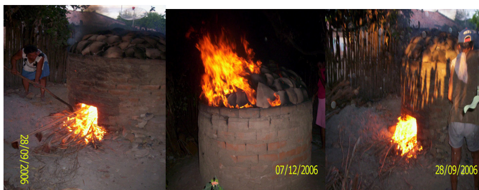
Figura 24 – Parte final da queima. O forno já está com uma grande quantidade de brasas em seu interior (à esquerda) e é dada a calda ; são produzidas labaredas que ultrapassam a altura do forno (centro) e o cobrem (à direita). Fonte: Francisca Mendes. Acervo pessoal. 2006.
